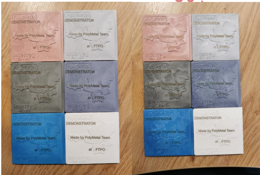
Abbildung 4: Produzierte Muster der Direktspritzgusstechnologie mit den Verbundwerkstoffen mit hoher Wärmeleitfähigkeit und Zugabe von metallischen Masterbatches (von oben nach unten und von links nach rechts: PA 6, PP, ABS, PS, PC) im Prototypenwerkzeug
