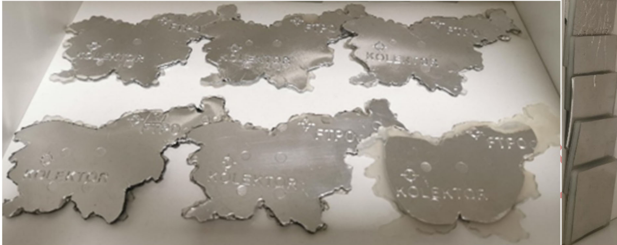
Abbildung 5: Produzierte Muster der IML-Technologie mit unterschiedlichen Dicken von Al-Folien
