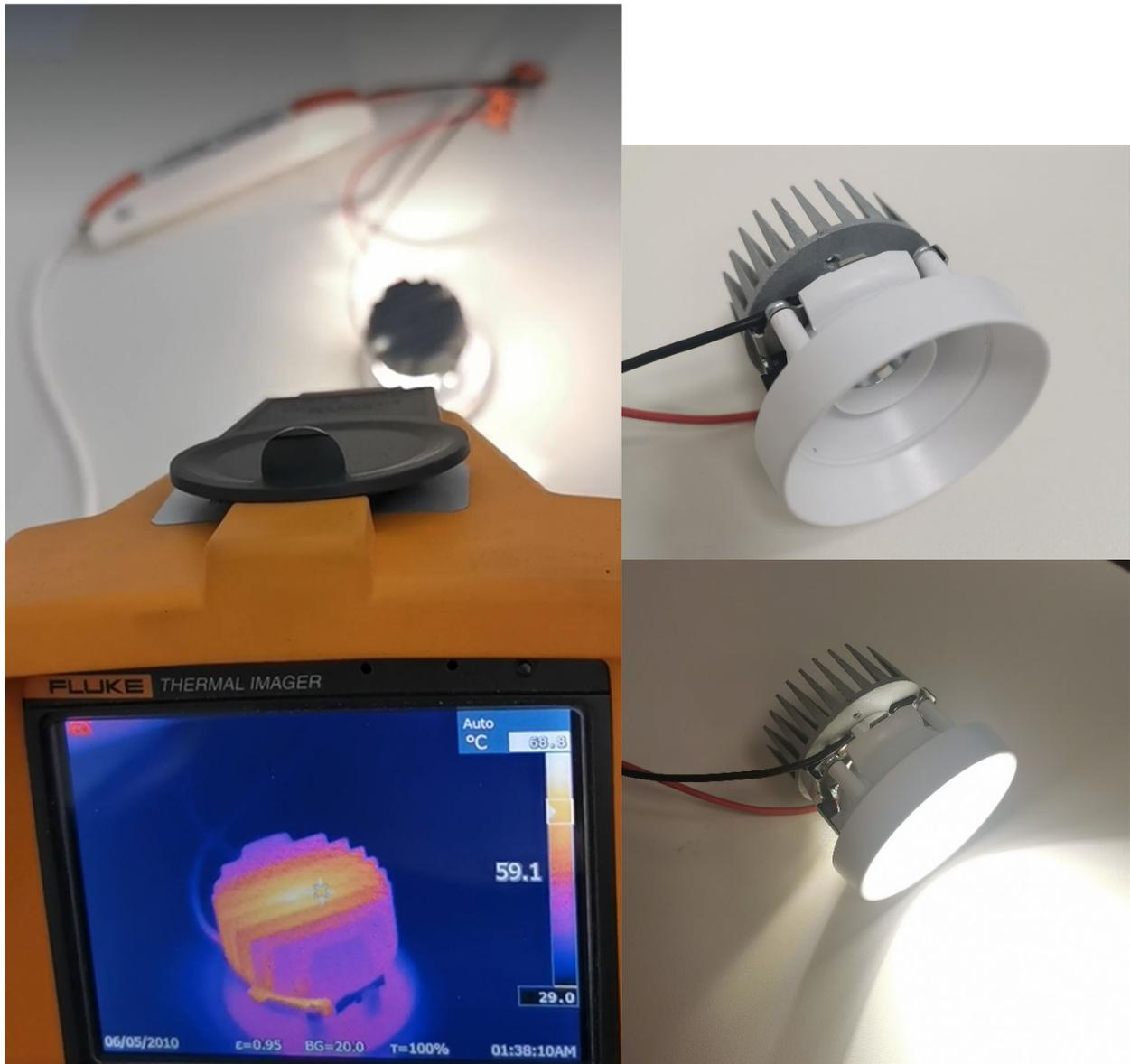
Abbildung 3: Intra-Beleuchtungsdemonstrator, getestet mit Wärmebildkamera
