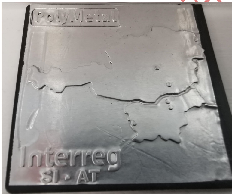
Abbildung 6: Mit dem Prototypwerkzeug hergestellte Proben (Verbundwerkstoff mit hoher Wärmeleitfähigkeit - oben, IML-Technologie - unten)
