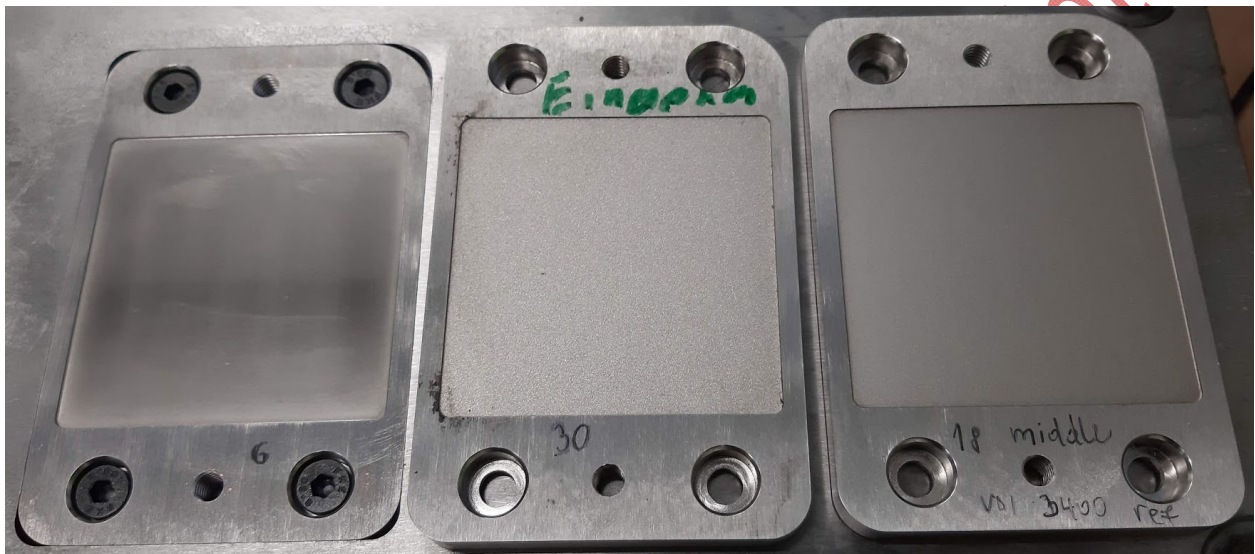
Abbildung 1: Prototyp-Werkzeugeinsätze mit unterschiedlichen Oberflächenrauheiten
