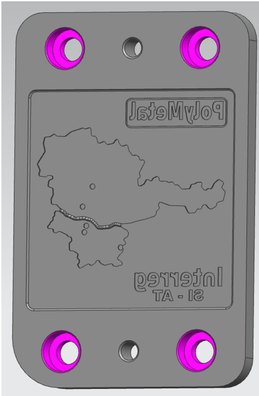
Abbildung 5: Prototypen-Werkzeugeinsätze mit verschiedenen Oberflächenrauigkeiten und mit PolyMetal & Interreg SI-AT Logos und SI-AT Karten - 3D Zeichnung
