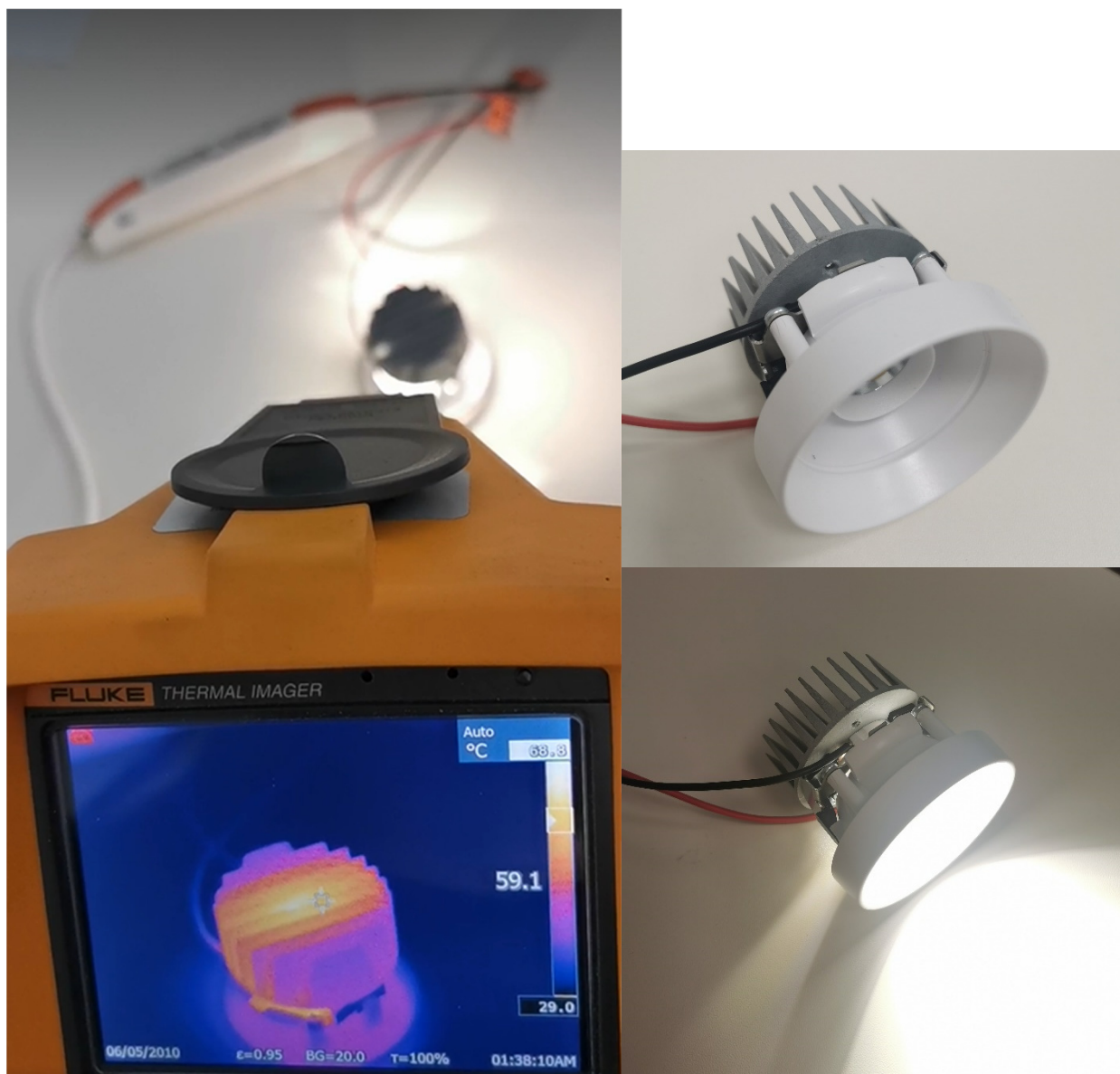
Slika 3: Demonstrator Intra lighting, testiran s toplotno kamero
