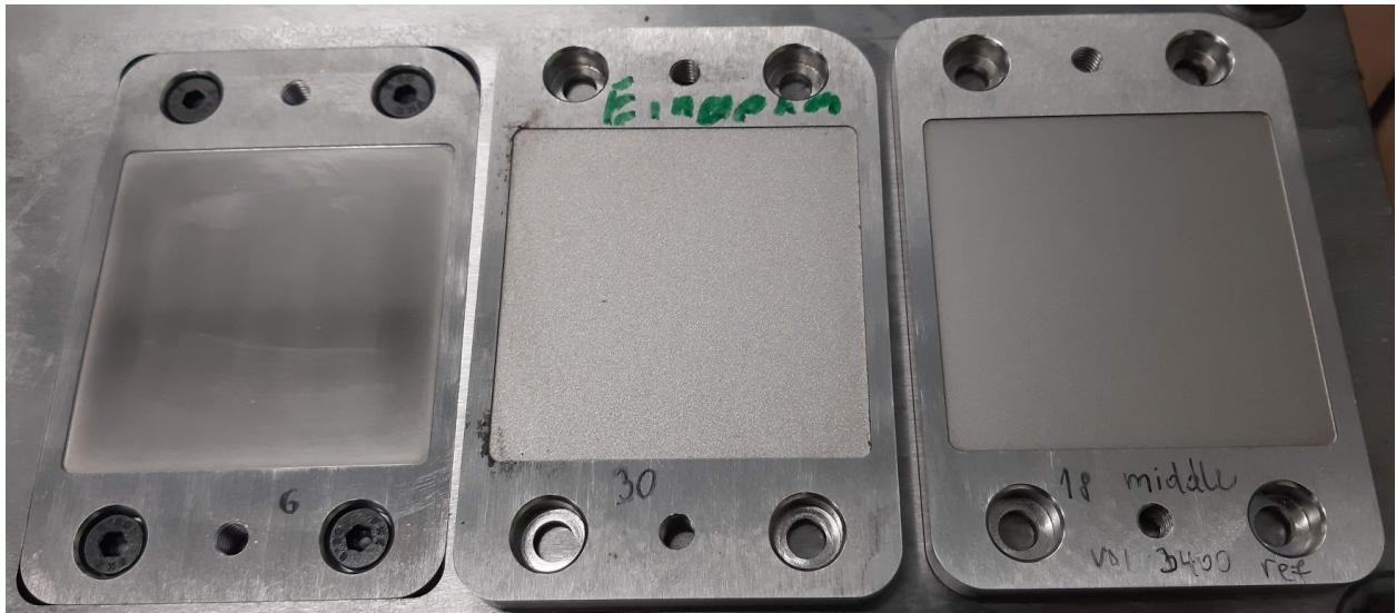
Slika 1: Prototipni orodni vložki z različnimi hrapavostmi površine
