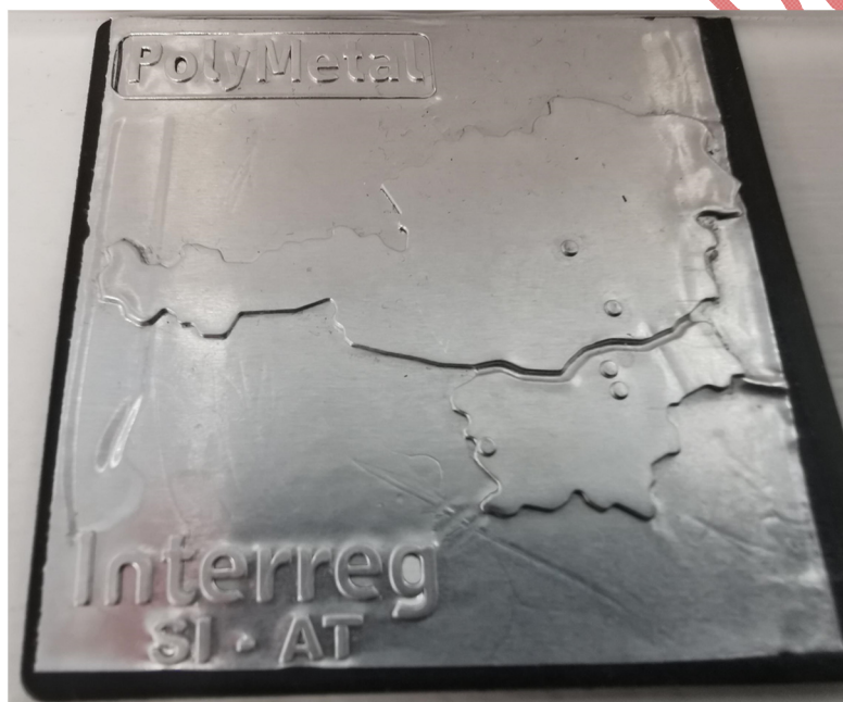
Slika 6: Vzorci, izdelani s pomočjo prototipnega orodja (kompozit z visoko toplotno prevodnostjo – zgoraj, tehnologija IML – spodaj)
