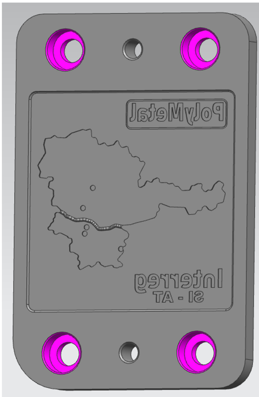
Slika 5: Prototipni orodni vložek z različnimi hrapavostmi površine in z logotipoma PolyMetal & Interreg SI-AT ter zemljevidoma SI-AT
