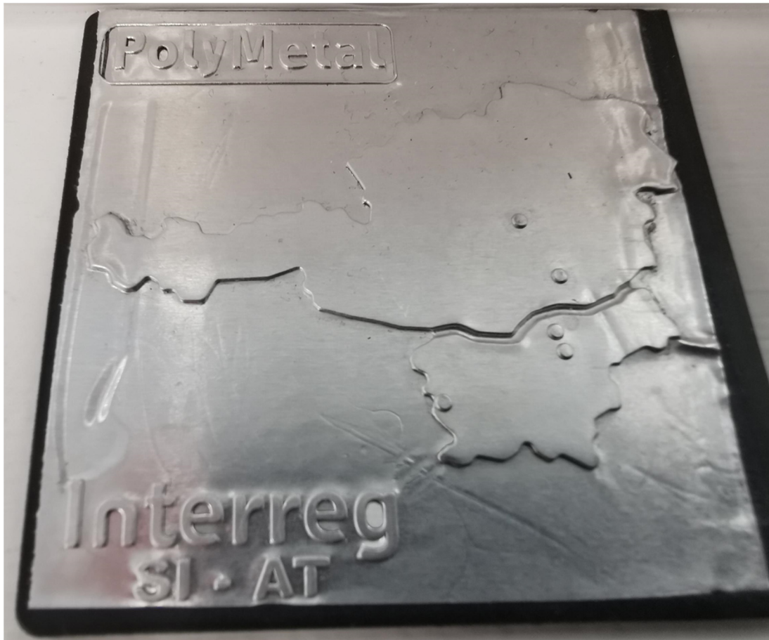
Slika 8: Izdelani vzorci s tehnologijo IML v prototipnem orodju
