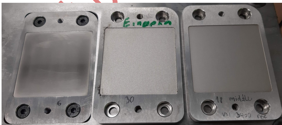
Slika 1: Prototipni orodni vložki z različnimi hrapavostmi površine
