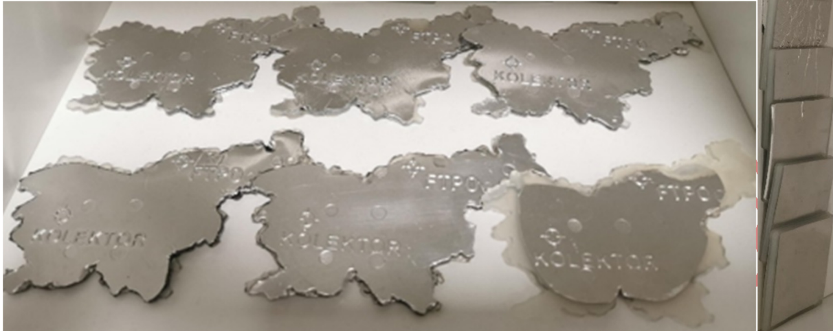
Slika 5: Izdelani vzorci s tehnologijo IML z različnimi debelinami aluminijastih folij
