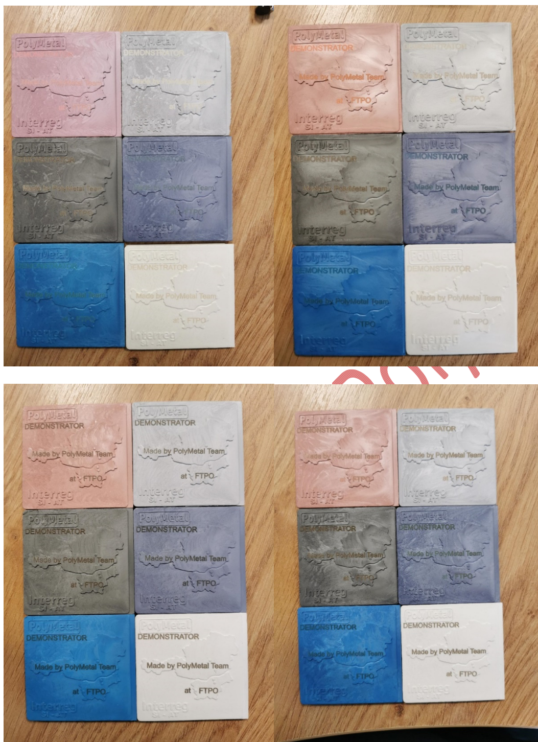
Slika 4: Izdelani vzorci s tehnologijo brizganja s kompoziti z visoko toplotno prevodnostjo in dodatkom kovinskih Master Batchev (od zgoraj navzdol in od leve proti desni: PA 6, PP, ABS, PS, PC) v prototipnem orodju
